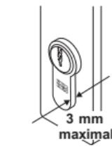
Zylinder mit eingeschwenktem Schließbart ins Schloss einführen. Einbau mit max. 3 mm Überstand.
